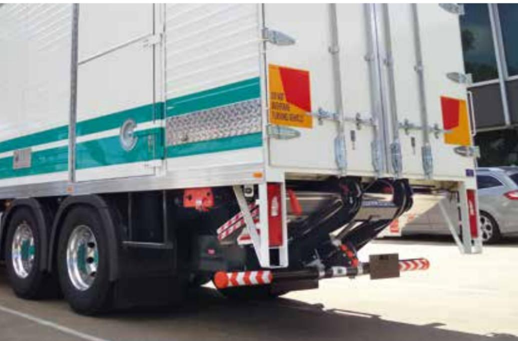
La DH-RC.15 es la plataforma replegable ideal para vehículos comerciales de **carga media**. Esta plataforma viene de serie con plato en forma de cuña con un **recorrido horizontal desde el piso del vehículo al suelo** (y viceversa), incluyendo **la inclinación automática a nivel de suelo**.
